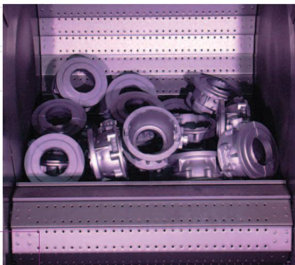
**Alcuni particolari grezzi ottenuti per fusione (a sinistra) prima dell'operazione di granigliatura in una macchina a Tappeto Rampante® e altri pezzi realizzati per fusione già sabbiati (a destra).**
