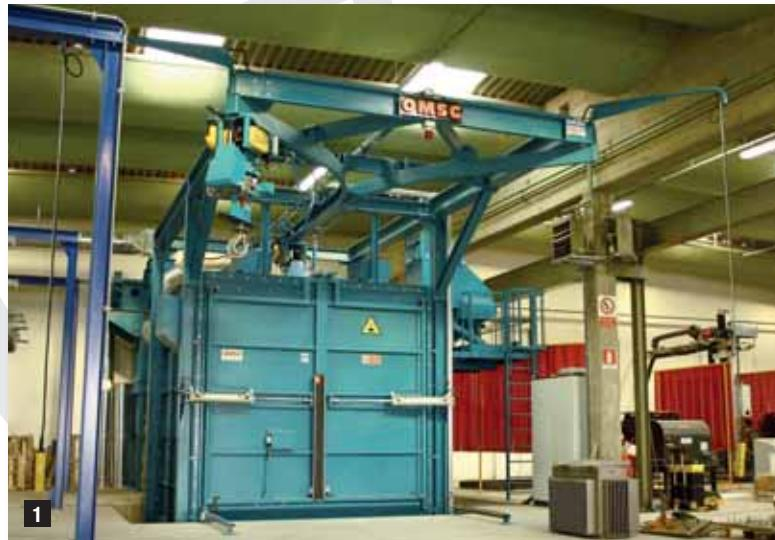
OMSG propone, per questo tipo di applicazione, una granigliatrice a paranco modello CAPRI (fig. 1). Il principio di funzionamento di queste granigliatrici è piuttosto semplice: il cassone viene appeso a un gancio, normalmente correddato di paranco per il sollevamento, e da questo spostato all'interno della camera di granigliatura. Le turbine lo investono con una quantità di abrasivo che solitamente è compreso
