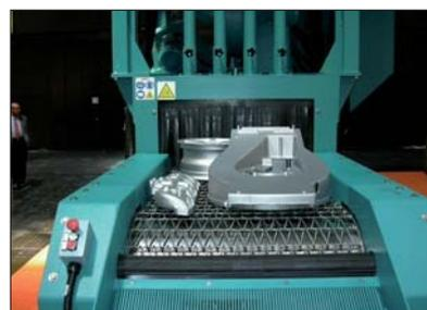
I pezzi da trattare vengono posizionati su un nastro in rete di acciaio speciale ad alta resistenza all'usura, che li movimentata attraverso la camera di granigliatura, all'interno della quale sono sottoposti al flusso di abrasivo lanciato
