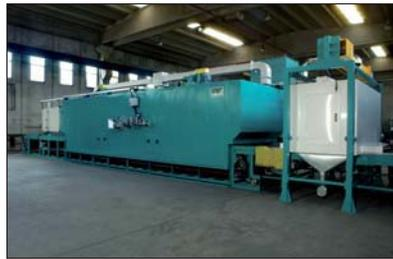
stemi di lavaggio e forni per l'asciugatura e polimerizzazione di vernice di contenitori in alluminio
