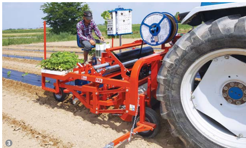
Figura 3: Con l'avvento del biologico, Ferrari Costruzioni Meccaniche ha introdotto nella propria produzione una trapianta pacciamatrice meccanica, in grado di stendere un film in polietilene o biodegradabile, che impedisce la crescita di infestanti senza dover utilizzare prodotti chimici.
