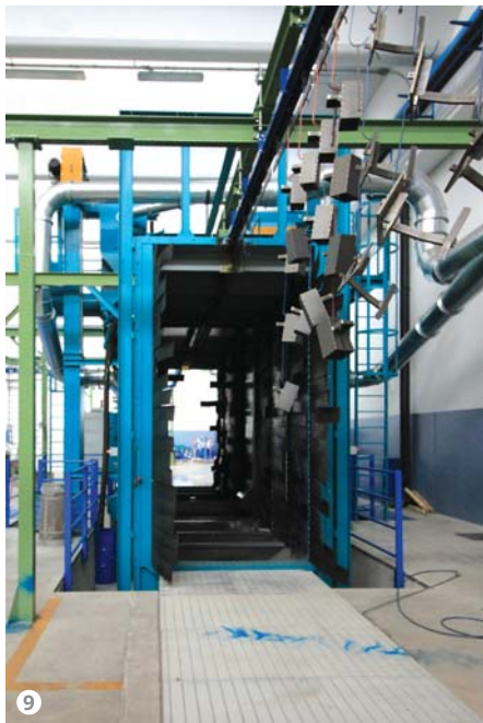
Figura 9: L’abrasivo può essere recuperato e ricondizionato: l’operatore, attraverso una lancia di soffiaggio, rimuove la graniglia rimasta sul pezzo che viene raccolta nelle tramogge poste in uscita dal processo.
