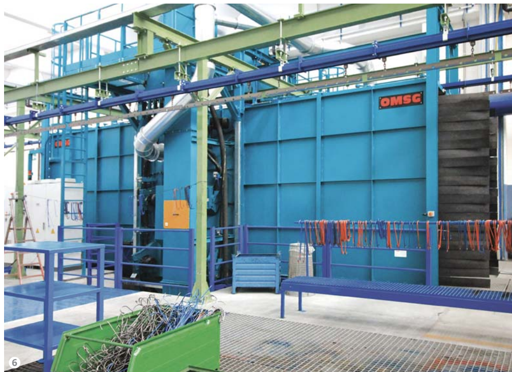
Figura 6: La granigliatrice a tunnel TUNNELBLAST 1525/12 installata a dicembre 2017 da OMSG (Villa Cortese - MI).
