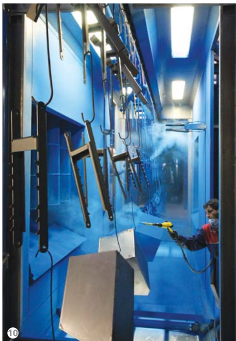
Figura 10: La cabina di verniciatura a polvere è dotata di 4 reciprocatori e due pistole per il ritocco manuale di Wagner e impiega polveri poliesteri di Sherwin-Williams.
