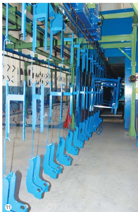
Figura 11: I pezzi all’entrata del forno di polimerizzazione.
