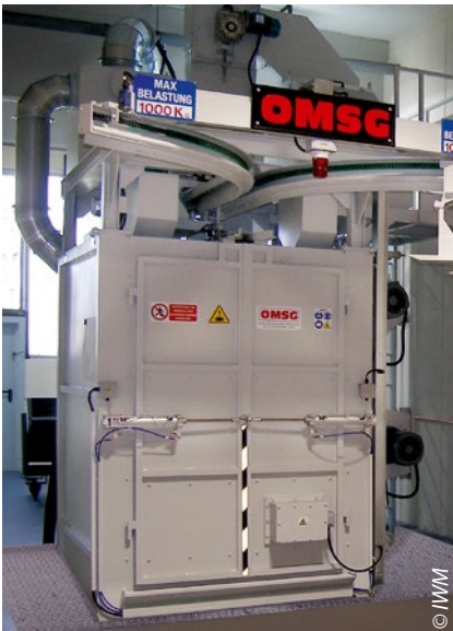
Eine Hängebahnstrahlanlage bei Hawle Freilassing mit Schleuderradturbine. Für das Aufräumen von Armaturen kommt Stahlguß-Strahlmittel zum Einsatz (kantig GH 16, 1,0 - 1,6 mm, Härte 60-64 HRC)
