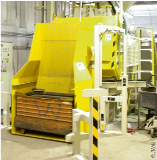
Eine Muldenbandstrahlanlage bei Gotec (USA). Für das Aufräumen von Metall-Teilen kommt Stahlguß-Strahlmittel zum Einsatz (kantig GH 50, 0,3 - 0,6 mm, Härte 60-64 HRC).
