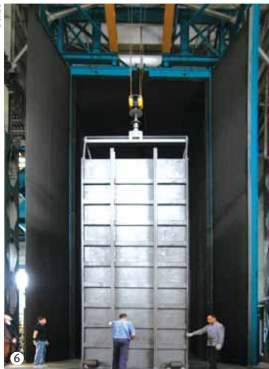
Figura 6: La fase di posizionamento di una grande cassa all'interno della granigliatrice.
