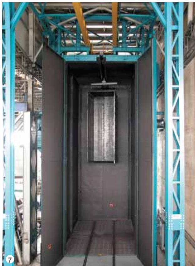
Figura 7: Interno della camera di granigliatura.
