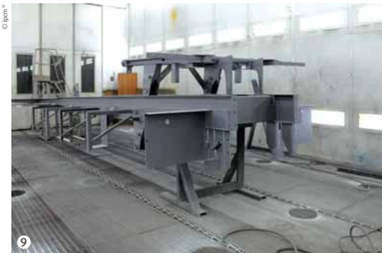
Figura 9: Un telaio granigliato pronto per la verniciatura.
