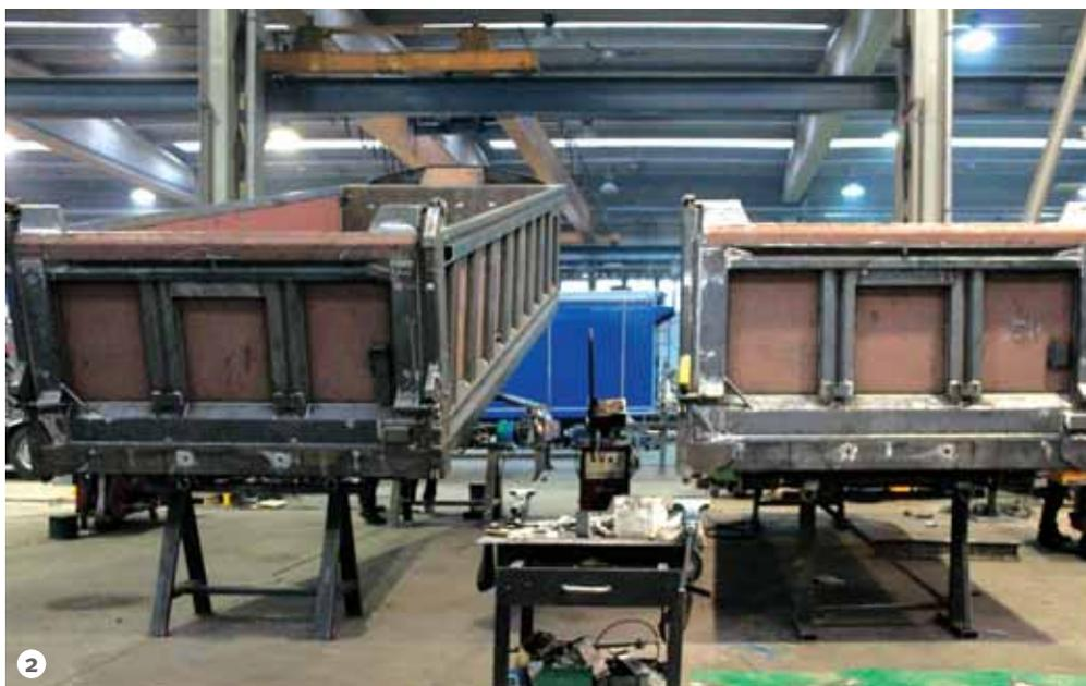
**Figura 2: La fase di costruzione delle casse scarrabili.**
