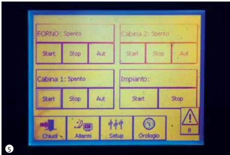
Figura 5: il touch screen di comando della granigliatrice.
